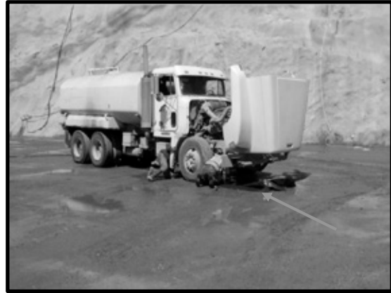
Ilustración 123. Colocación de bases plásticas durante reparación "in situ".
