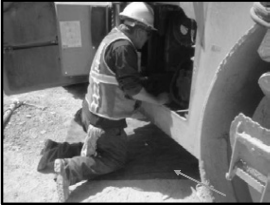
Ilustración 124. Implementación de bases plásticas durante reparación "in situ".
