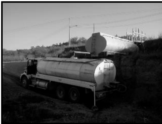
Ilustración 25. Retiro de agua tratada mediante pipa con capacidad de 20,000 litros.
