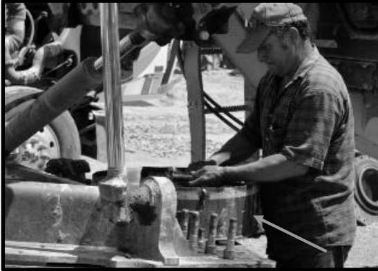
Ilustración 140. Uso de charolas para retención de líquidos durante mantenimiento a equipos.
