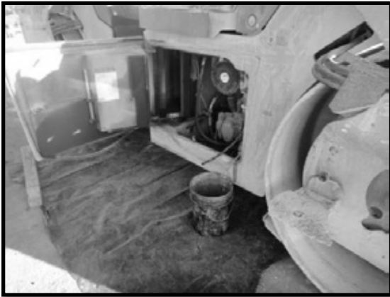
Ilustración 80. Colocación de bases plásticas en el equipo mayor para evitar derrames al suelo.
